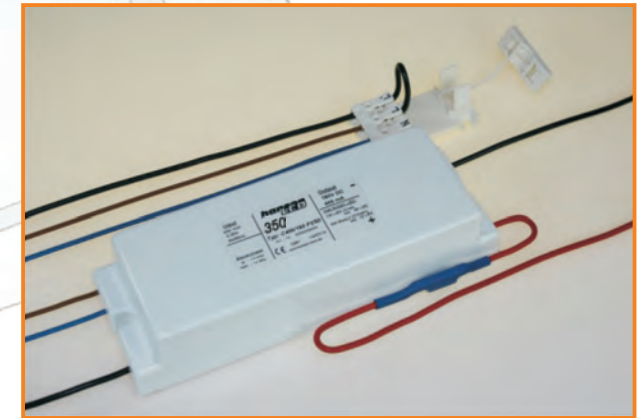
Der Converter 350 mA/180 Volt hat die Schutzart IP 67 und Schutzklasse II. Absenkung auf 175 mA durch Abschalten der Steuerphase ist möglich. Das bauseitige Anschlußkabel braucht nur an die vorhandene 230 Volt-Klemme angeschlossen zu werden.
